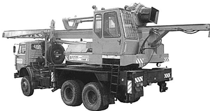
Рис. 7. Общий вид копра на базе автомобиля КамАЗ – УГМК 12.
