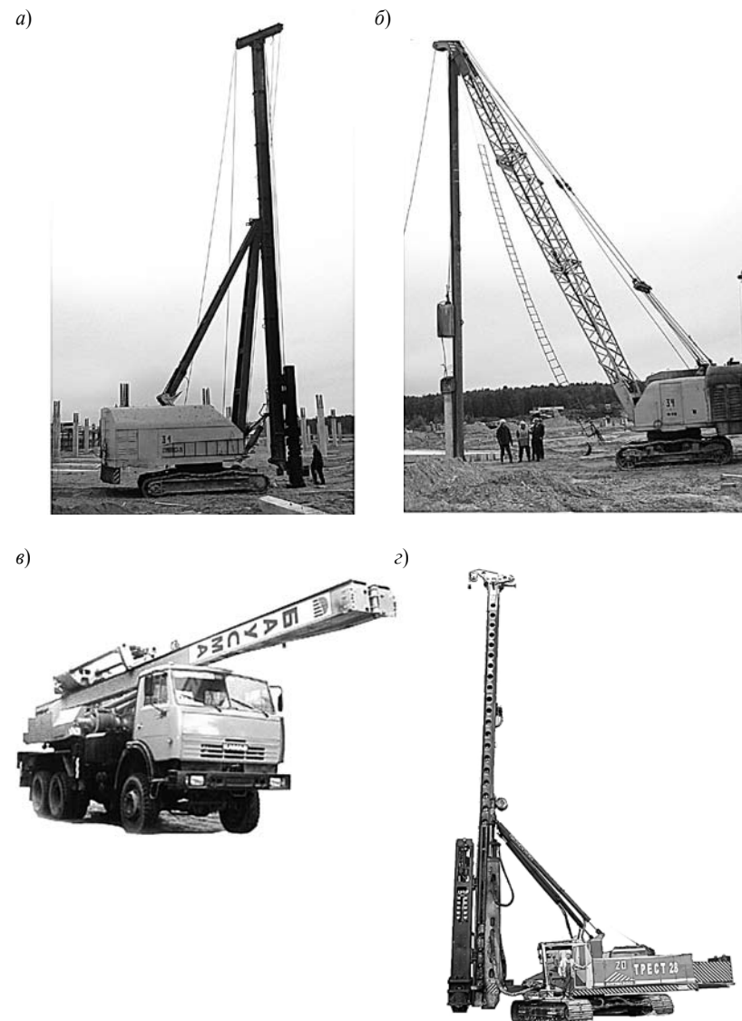
Рис. 8. Общий вид копров разных типов: а – полноповоротный копер с дизельным молотом; б – копер со стоечной мачтой с механическим молотом свободного падения; в – копер на базе автомобиля; г – универсальный копер с гидравлическим молотом
