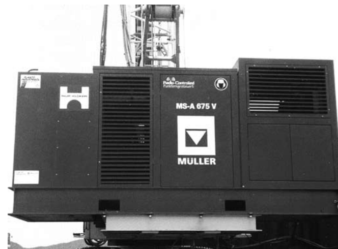
Рис. 39. Общий вид гидравлической станции привода вибропогружателя
