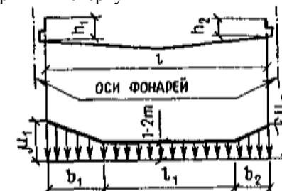
$\mu_1 = 1 + m \left( 2 + \frac{l_1}{h_1} \right); \quad \mu_2 = 1 + m \left( 2 + \frac{l_1}{h_2} \right)$ <p>Значения <math>b(b_1, b_2)</math> и <math>m</math> следует определять в соответствии с указаниями к схеме 8; пролет <math>l</math> принимается равным расстоянию между верхними кромками фонарей</p>
