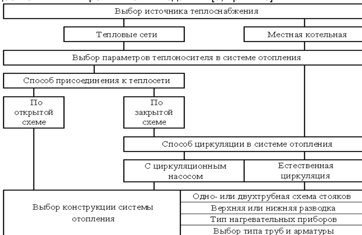
Рис. 4.1. Рекомендуемая последовательность выбора конструкции системы водяного отопления
