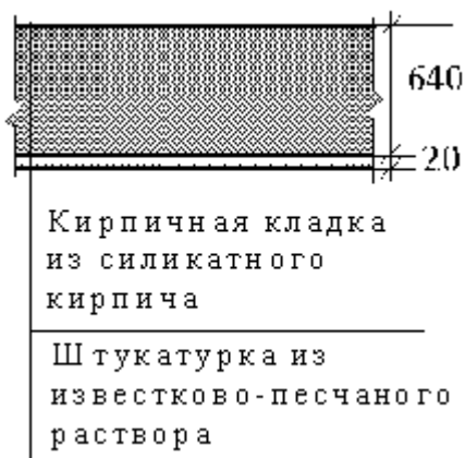
Рис. 3.4. Схема конструкции наружной стены
